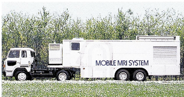
Fig. 1 車両搭載型MRI検診車(モバイル車) 全長: 13.6m, 幅員: 2.49m, 車高: 3.66m, 重量 25.560kg 0.2T永久磁石型MRI装置MRP-20(日立メディコ 社製)を搭載
